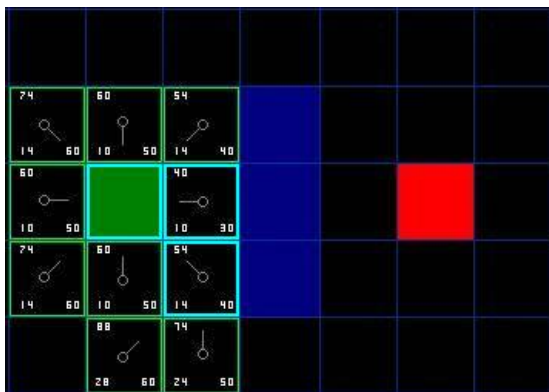
Fig. 10.3: Din nodurile marcate selectăm nodul cu valoare minimă conform funcției de cost și marcăm vecinii acestuia iar apoi pașii se repetă pentru următorul nod cu valoarea minimă etc Sursa: Patrick Lester, A* Pathfinding for Beginners
